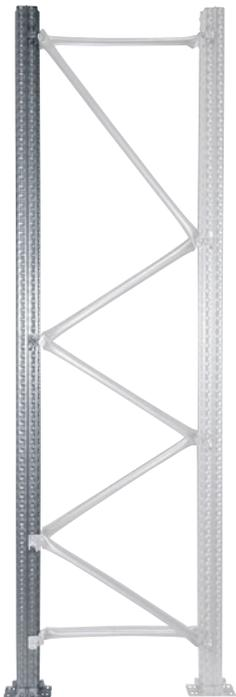
Sie erhalten die Rahmen komplett in verzinkter Ausführung. Aus transporttechnischen Gründen werden die Rahmen zerlegt geliefert. Feldlastangabe bei 1.000 mm freier Knicklänge und Fachabstand.
