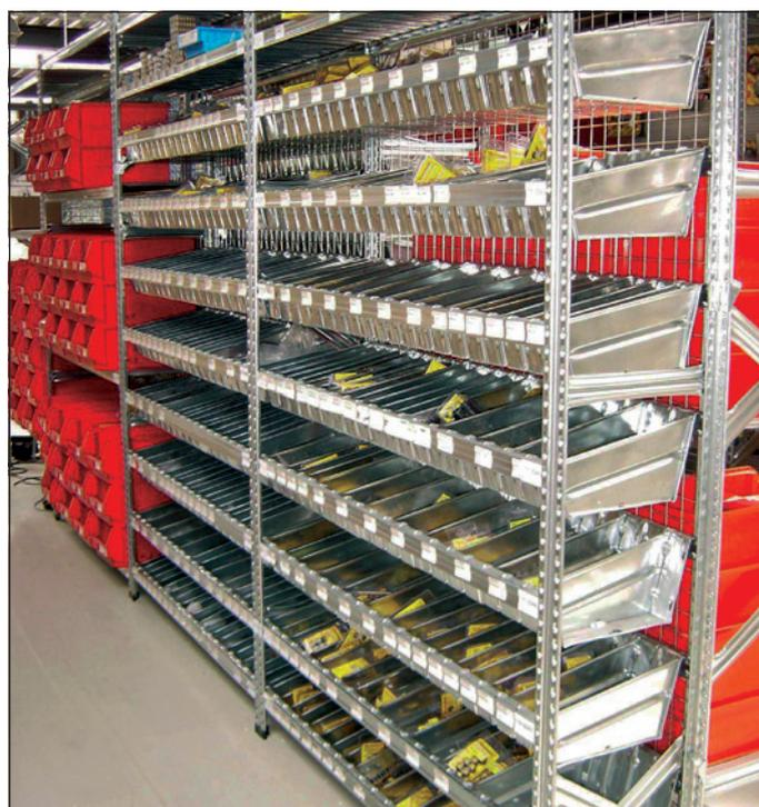
Gegen unbeabsichtigtes Aushängen von Lagerwannen sind Aushängesicherungen zu verwenden. Die Montage der Aushängesicherungen ist auf allen Längsträgern zwingend vorgeschrieben.
