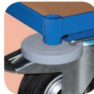
Abweisrollen geeignet für enge Transportwege, um z. B. Wände vor Beschädigungen, Schrammen usw. zu schützen. 100 mm Ø aus hellgrauem Kunststoff. Die Gesamtbreite erhöht sich um 70 mm. 1 Satz = 4 Stück
