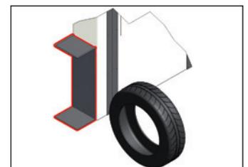
Vor der Einlagerung eines Reifens/Rades in das Regal, muss der maximale Reifendurchmesser mittels der Schablone überprüft werden.
