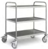
Edelstahl, ausgestattet mit 3 Borden, Tragkraft pro Bord: 40 kg, tiefgezogene Borde mit ringsumlaufenden, erhöhtem Profilrand. 4 Lenkrollen D=125 mm, in verzinkt-chromatisierten Gehäusen, davon 2 mit Totalfeststellern.
