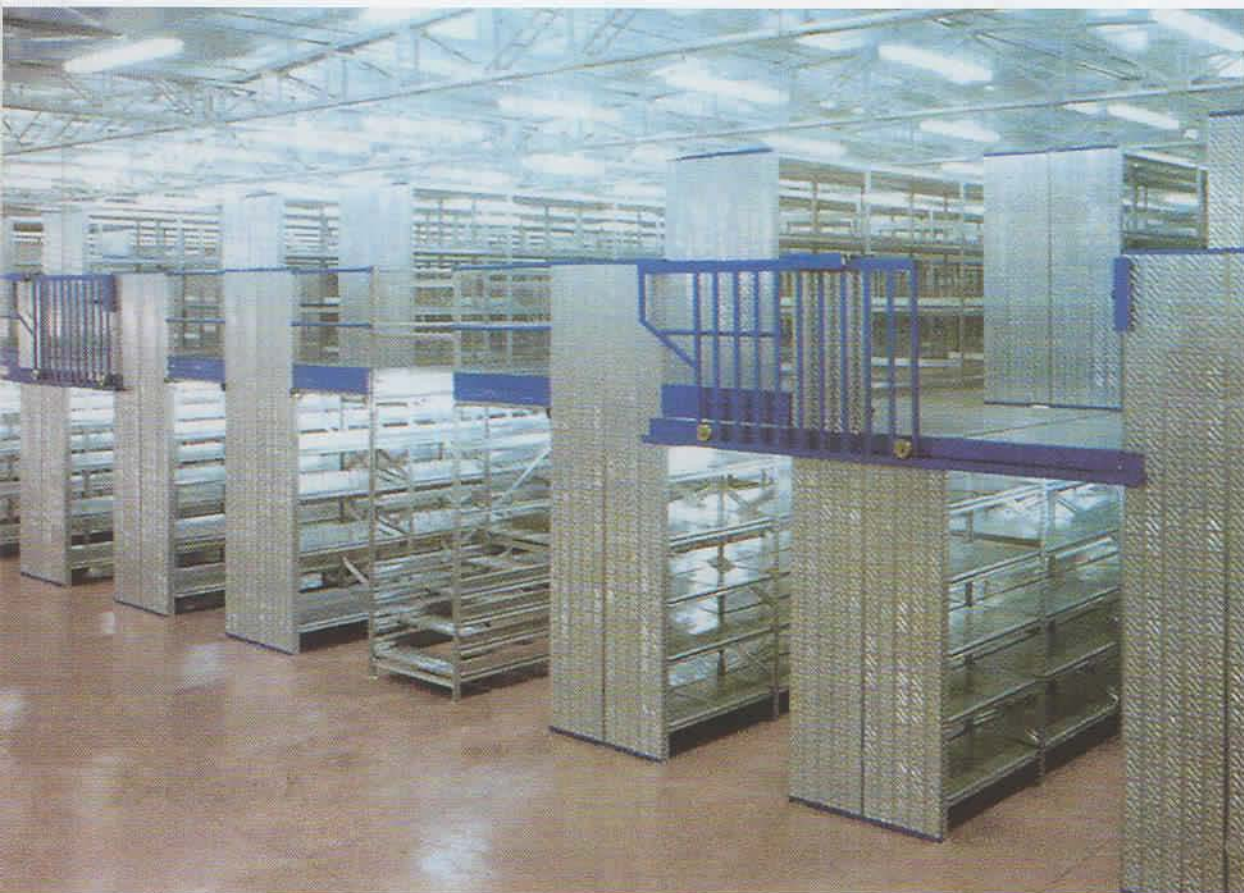
Zwei-Geschoß-Regalanlage mit Aufgabeplatz
