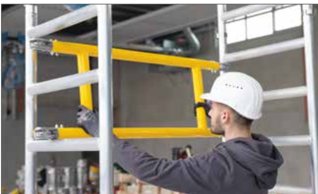
Pulverbeschichtete Geländerrahmen als Querstreben
